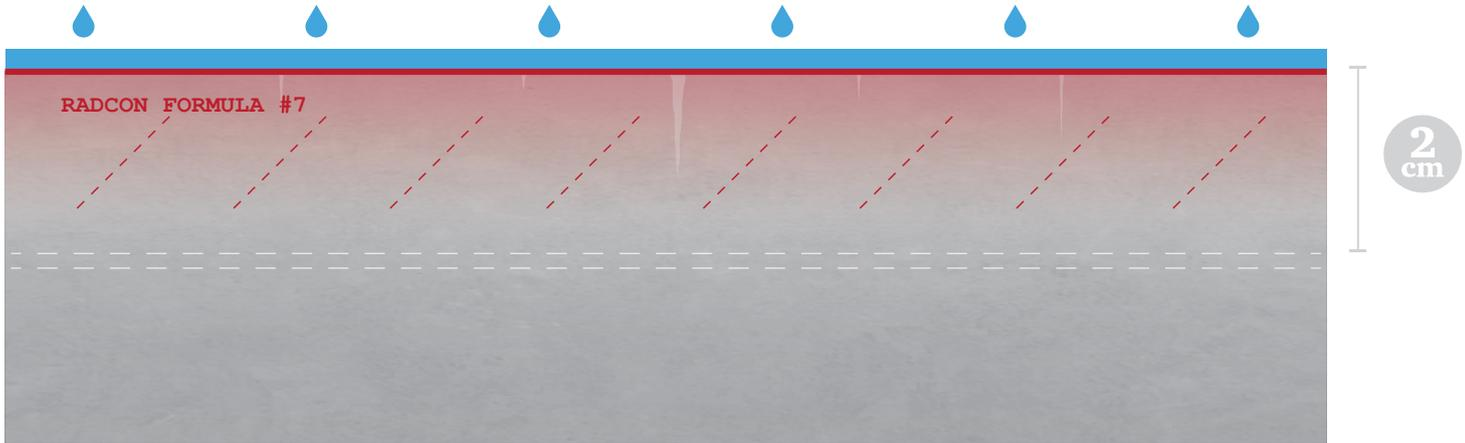
Mit Radcon Formula #7<sup>®</sup> behandelte Betonoberfläche ist zu 100% wasserdicht.
