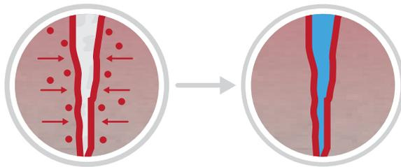
Mit Radcon Formula #7<sup>®</sup> behandelte Betonoberfläche mit Haarrissen von 0,2 bis 2 mm sind immer zu 100% wasserdicht. Die Risse werden durch die Expansion von Radcon Formula #7<sup>®</sup> langsam vollständig geschlossen.
