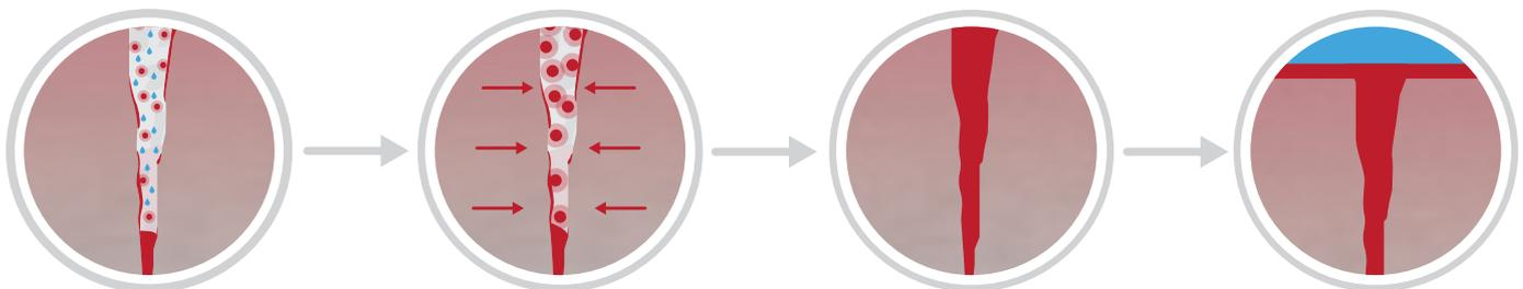
Mit Radcon Formula #7<sup>®</sup> behandelte Betonoberfläche mit Haarrissen bis zu 0,2 mm ist zu 100% wasserdicht. Die Risse werden durch die Expansion von Radcon Formula #7 vollständig verschlossen.
