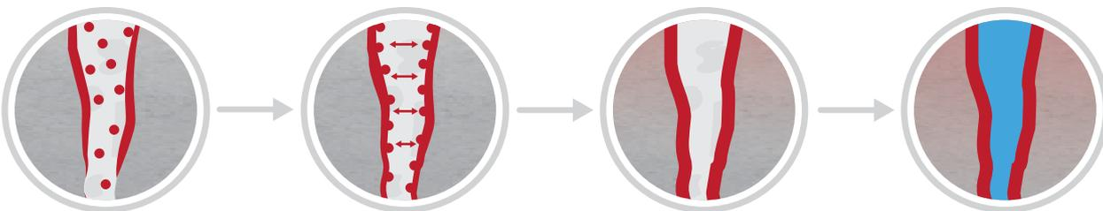
Nicht versiegelte Betonoberfläche welche Risse bis 2 mm aufweist kann mit Radcon Formula #7<sup>®</sup> komplett abgedichtet werden.
